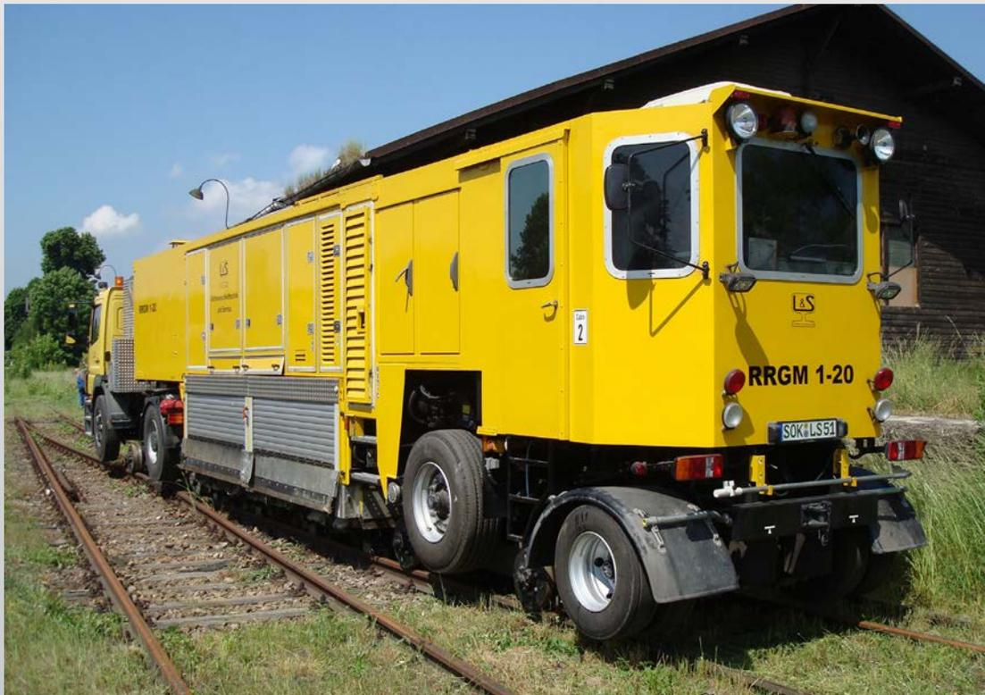
Die RRG 1-20 ist eine mobile Schienenschleifmaschine mit Zweiwegetechnik. Die Anlage verfügt über 20 unabhängig voneinander winkeleinstellbare Schleifspindeln, die mit je 7,5 bis 15kW frequenzgesteuerten Elektromotoren angetrieben werden. Der computergesteuerte Schleifprozess wird mittels Bildschirm vom Bediener überwacht.
